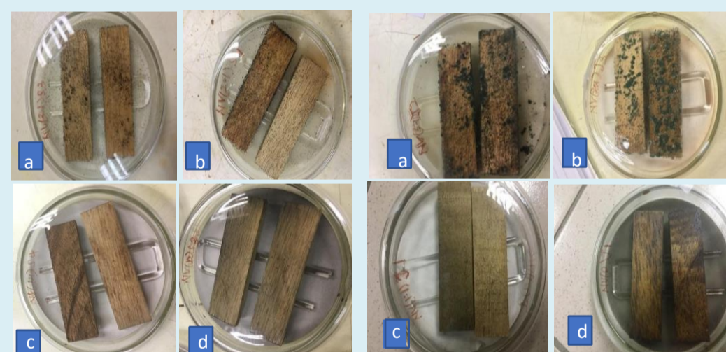
Fig. 4: Sesendok treated with NVWV 3:1 (a), 2:1 (b), 1:1 (c), undilute (d)
